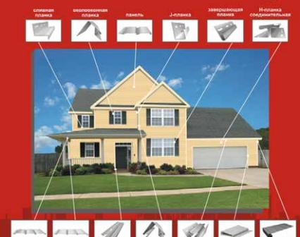
СЛИМКА ПЛИТКА, ОБОЛОЧКА ПЛИТКА, ПЛИТКА, J-ПАТЯ, ЗАКРЕПЛЯЮЩАЯ ПЛИТКА, ИСПОЛНЕНИЕ СОДЕРЖАТЕЛЬНАЯ
